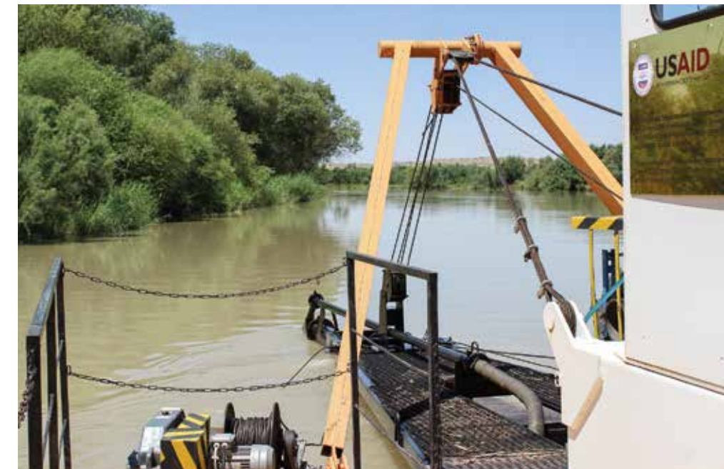
Земснаряд, закупленный в рамках проекта Smart Waters , в процессе очистки русла Мургаба от осадочных отложений
