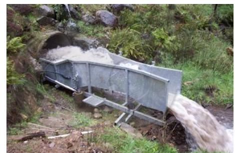
Лотки используются в составе расходомеров-счетчиков открытых потоков для измерения объемного расхода и объема жидкости в безнапорных открытых каналах в комплекте со вторичными измерительными приборами (ультразвуковыми расходомерами, датчиками гидростатического давления, уровнемерами различных типов).
