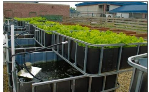
По мере роста рыб вода фильтруется с помощью гравитационного метода, чтобы вода не содержала крупных твердых частиц. Затем вода перекачивается в каналы, в которых выращиваются водные растения. В конце канала небольшой насос отправляет воду обратно в аквариум.
