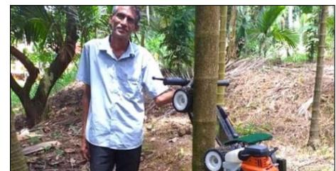
Машина работает с ремнем безопасности, сиденьем и ремнем безопасности и использует небольшой двигатель и набор колес, чтобы захватывать багажник без использования рук.
